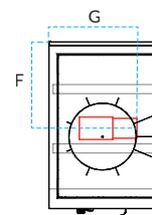
(1) Zentralheizungsherde mit Rauchausgang links sind symmetrisch. Die externe Frischluftzufuhr befindet sich immer auf der Seite der Brennkammer.
