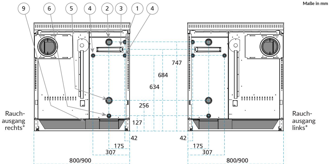
Der zur Verfügung stehende Zwischenraum zwischen Anschlüssen und der Wand des Aufstellraums beträgt ca. 30 mm. Bei Bedarf könnte es notwendig sein, einen größeren Zwischenraum mit einem in der Tiefe verlängerten Herdrahmen oder mit einer Nische in der Wand zu schaffen.
