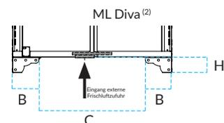
(1) Holzherde mit Rauchausgang links sind symmetrisch. Die externe Frischluftzufuhr befindet sich immer auf der Seite der Brennkammer.
