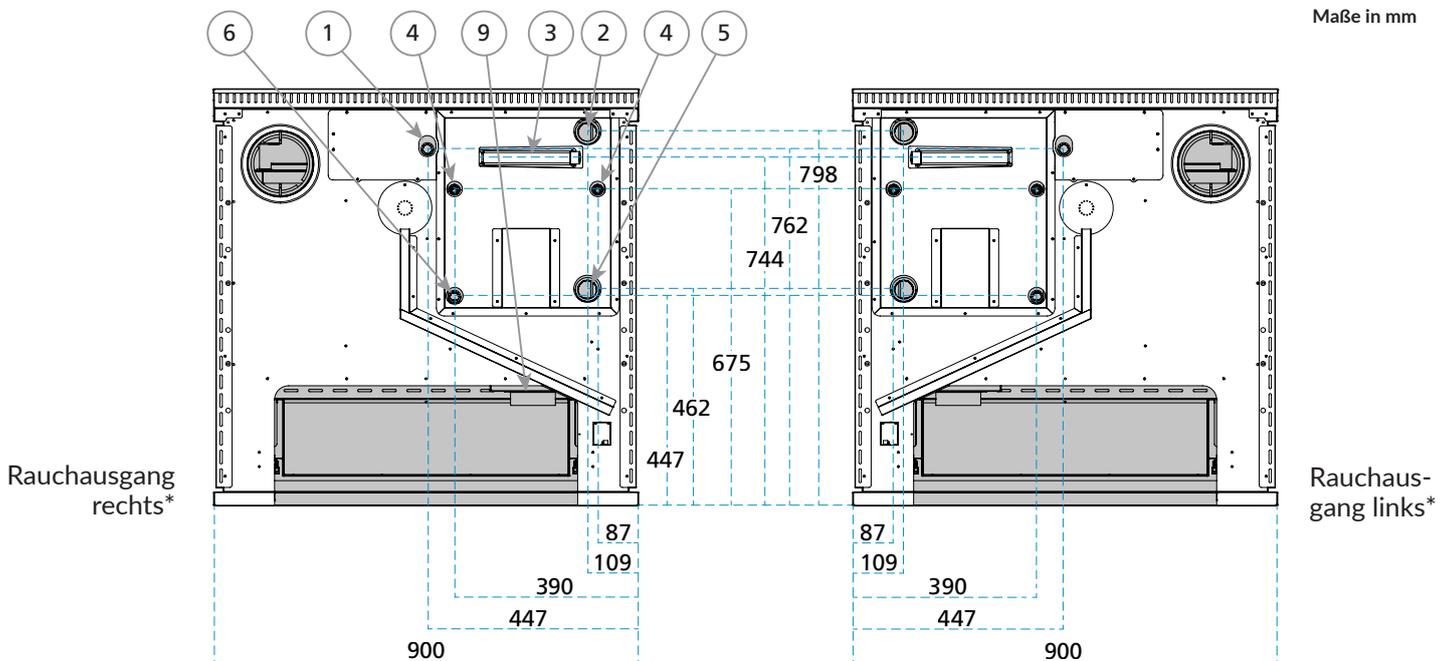
Der zur Verfügung stehende Zwischenraum zwischen Anschlüssen und der Wand des Aufstellraums beträgt ca. 14 mm. Bei Bedarf könnte es notwendig sein, einen größeren Zwischenraum in der Tiefe durch eine zusätzliche Wischleiste oder mit einer Nische in der Wand zu schaffen.
