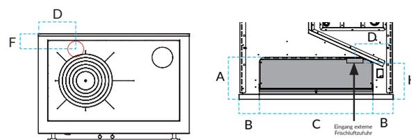
(1) Holzherde mit Rauchausgang links sind symmetrisch. Die externe Frischluftzufuhr befindet sich immer auf der Seite der Brennkammer.
