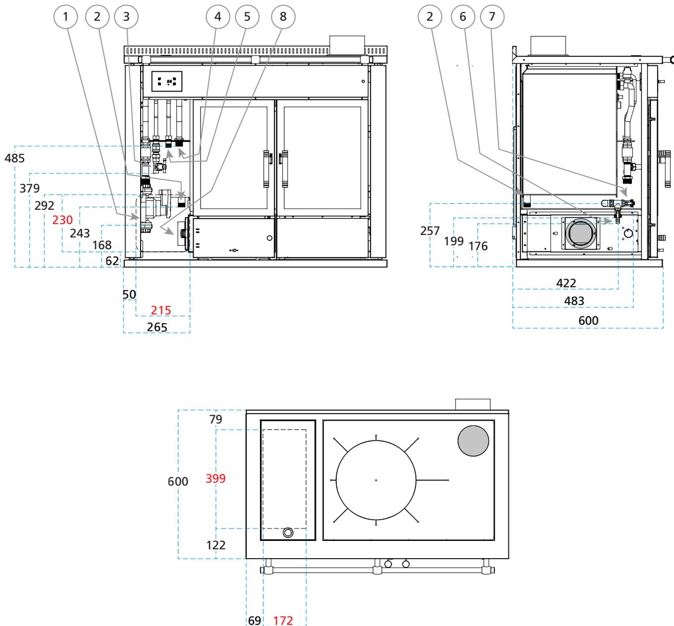
Die Positionen und Maße der Öffnungen für den Durchgang der Leitungen sind in Rot gekennzeichnet.
